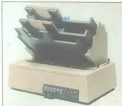
IBM 8008 Quietwriter III s aparatom za dočuvanje pojedinih listova
